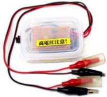
コッククロフト型高電圧ユニットはインバータ回路と高耐圧のコンデンサー、ダイオードにより 2kV(EX型は4kV)程度の直流高電圧を得られます。これにより空気中の雑イオンを除去し、通常観察が難しい環境でも観察を可能とします。
