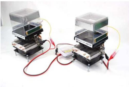
一台の直流電源装置と高電圧ユニットで、2台の本体を動作させることが出来、同時に $\alpha$ 線と $\beta$ 線を観察して比較できます。
