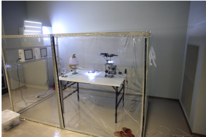
HEPA フィルターを使用した大型 クリーンブース: 1.5 \times 1.5 \times 2.4\text{m}
