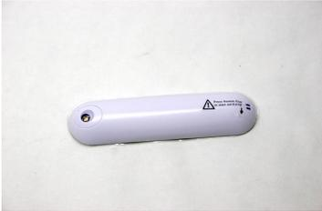
以前はUV-C光源として低圧水銀ランプについてのみ考えれば良かったが、近年260nm程度までの波長のLED光源が販売されるようになった。しかし、多くの製品で使用されている280nmでは不活化の効果は254nmの場合の1/10程度であり、紫外分光放射照度計での測定と波長毎の効果の評価が必要。
