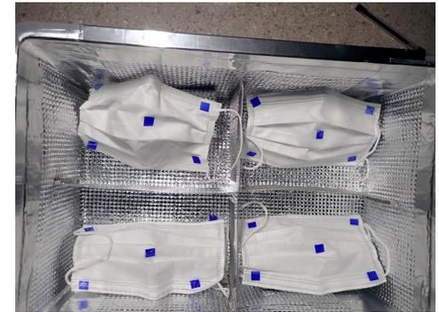
紫外放射照度計と、ラジオクロミックフィルムにより評価された吸収線量率の距離依存性の相関から、吸収線量  $I$  (kGy) と、紫外線の積算照度  $D$  ( $\text{mJ}/\text{cm}^2$ ) の間で  $D = 1.62 I$  と言う簡単な校正式を導いた。透過試験から、 $45\mu\text{m}$ フィルム内で完全にUV-Cは吸収されており、 $16.2\mu\text{m}$ までの範囲で均等に吸収されたとするとこの校正式が説明出来る。
