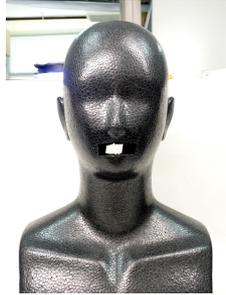
マスク着用が可能なトルソーの後方からパーティクルカウンターのノズルを入れ、一般的な3層不織布マスク着用による飛沫低減効果を検証した。
