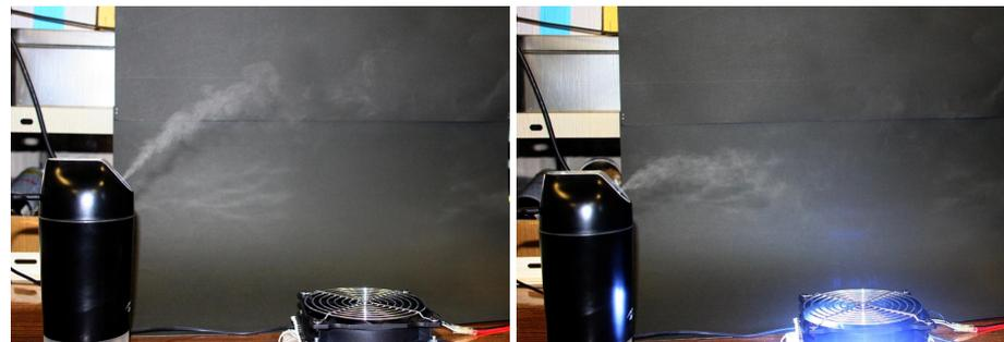
風速0.6m/s程度のクリーンベンチ内での飛沫捕集試験を行った。超音波加湿器からの水道水の液滴を、下流側に設置したパーティクルカウンターで測定する。液滴は斜めに噴射され、40cm程度の高さで水平に飛行した。
