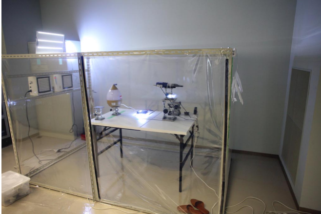
HEPA フィルターを使用した大型 クリーンブース: 1.5 × 1.5 × 2.4m
