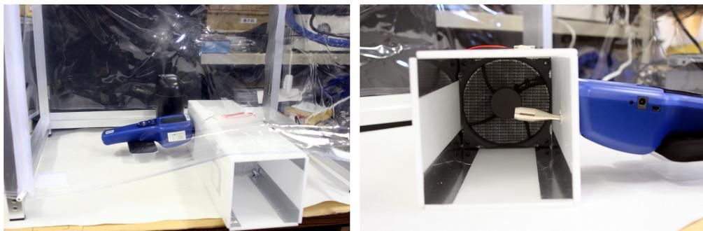
HEPAフィルターを使用したクリーンブース内にダクトを設置し、口腔からの飛沫を模擬した超音波加湿器からの液滴がどの程度フィルターに捕獲されるかを評価しました。
