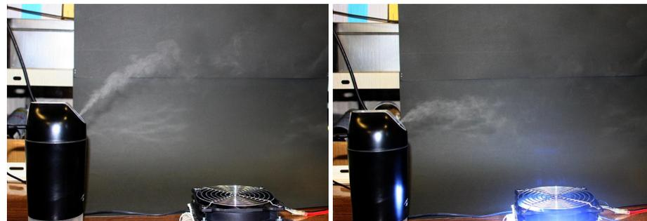
風速0.6m/s程度のクリーンベンチ内での飛沫捕集試験を行った。超音波加湿器からの水道水の液滴を、下流側に設置したパーティクルカウンターで測定する。液滴は斜めに噴射され、40cm程度の高さで水平に飛行した。
