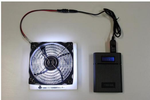
12cm角、高さ5cm、ファンの騒音19dB、消費電力5W以下で、モバイルバッテリーでの駆動も可能
