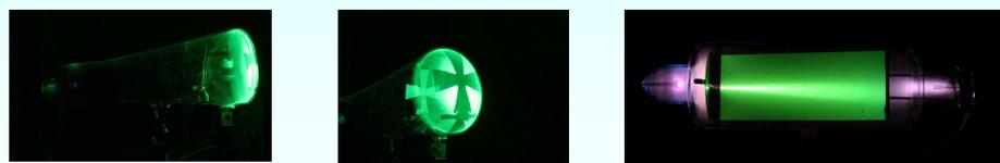
現行の教科書にも記載されているクルックス管は、製品によっては 15cmの距離で、 $70\mu\text{m}$ 線量当量率が  $200\text{mSv/h}$  にも達する高い線量率の低エネルギーX線が放出されている場合があります。知らないで近付いたりすると非常に危険です。
