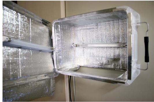
UV-C 照射により、物体表面に付着した菌・ウイルスを殺菌・不活化することで、接触感染リスクを低減する。
