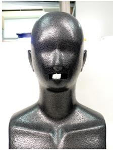
マスク着用が可能なトルソーの後方からパーティクルカウンターのノズルを入れ、一般的な3層不織布マスク着用による飛沫低減効果を検証した。
