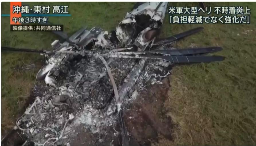
この大型輸送ヘリコプターCH-53の回転翼の根本付近に**安全監視システム (IBIS)**があり、1回転翼ごとに500マイクロキュリーの放射性ストロンチウムが搭載されている。※2
