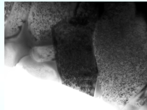
0.5 \mu\text{m} 中性子照射した \beta\text{-Si}_3\text{N}_4 の 明視野(Bright Field)像
